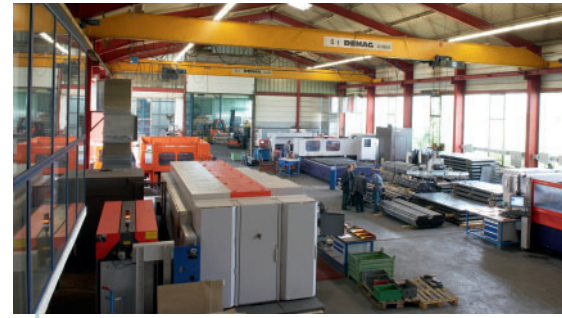
Laser im Zentrum: Die vier Laserschneidanlagen von Bystronic im ›Schneidsaal‹ sind die Basis für den Erfolg des seit sieben Jahren bestehenden Zweigbetriebs von Schwärzler in Röthenbach
